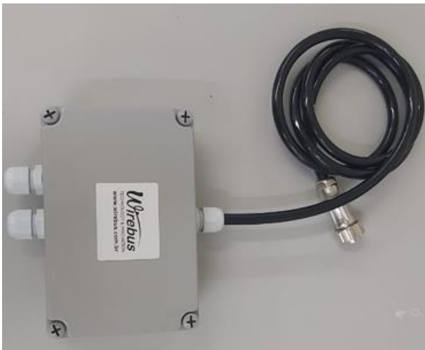
Figura 55 - Caixa de Passagem - Montagem Final
