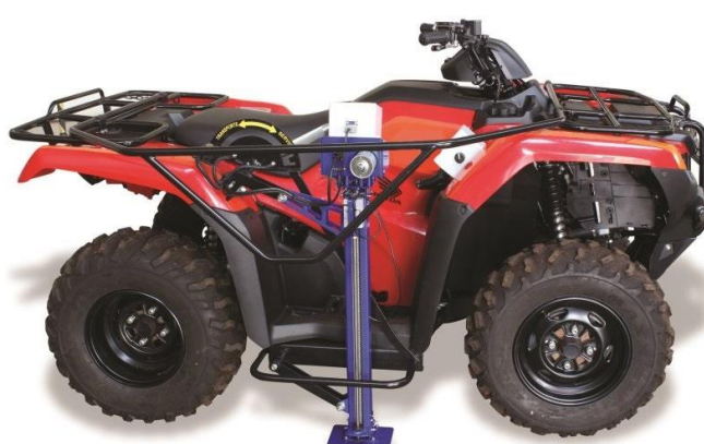
Foto 2: Alavanca travada na posição "Serviço"
