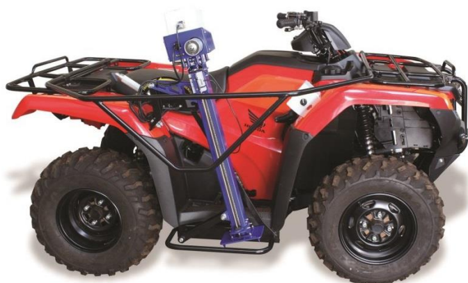
Foto 1: Alavanca travada na posição "Transporte"
