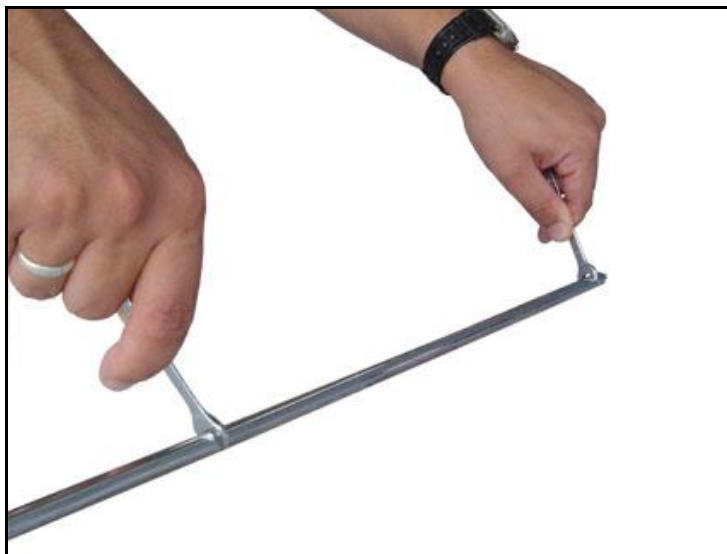
Figura 8 - Conexão das Hastes
