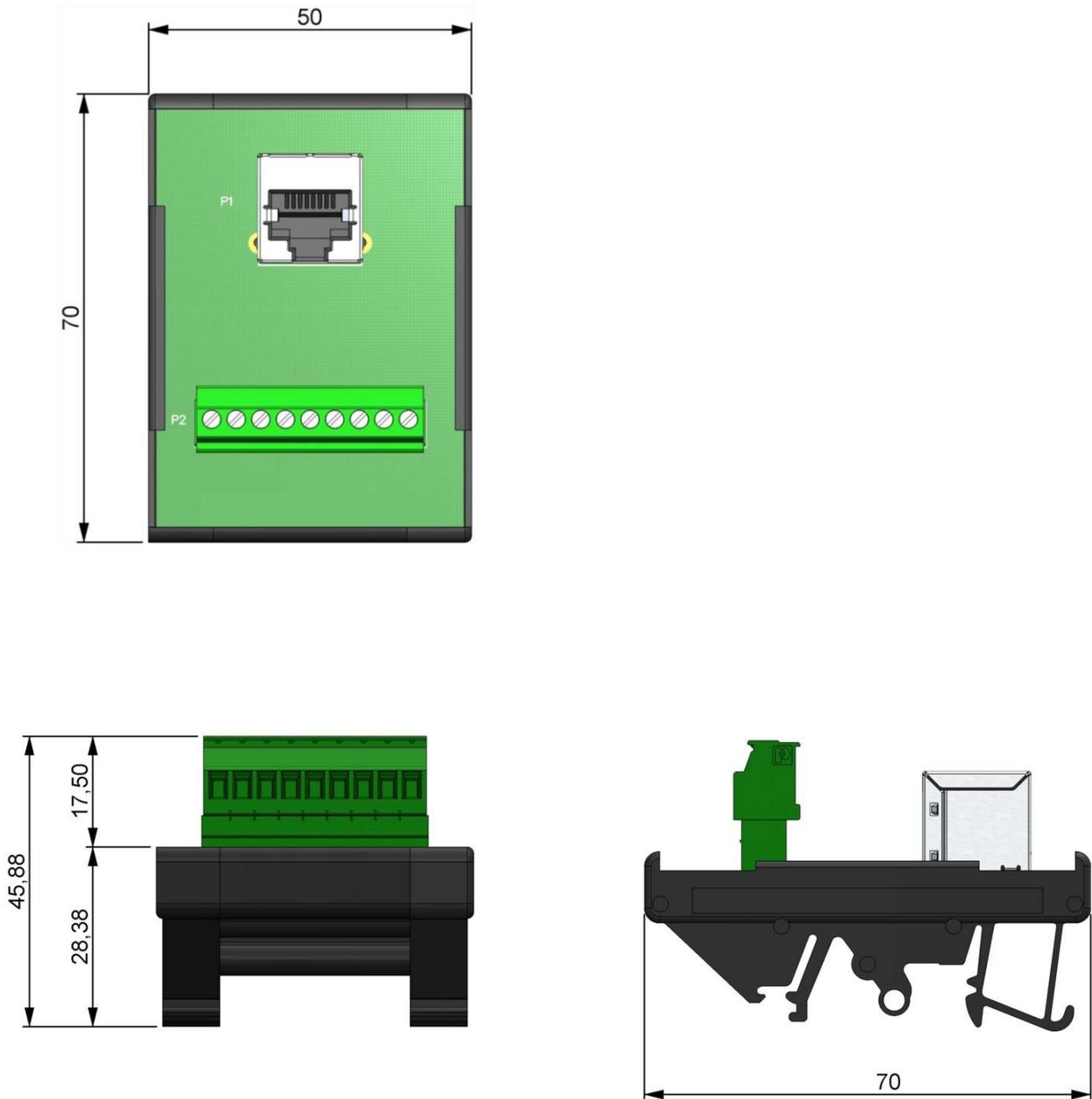
Figura 1 – Dimensionamento para montagem (cotas em milímetro)
